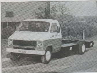
Caminhão elétrico Dodge 50 desenvolvido pela Chloride. Os conjuntos de baterias podem ser vistos nas laterais e traseira do veículo.
