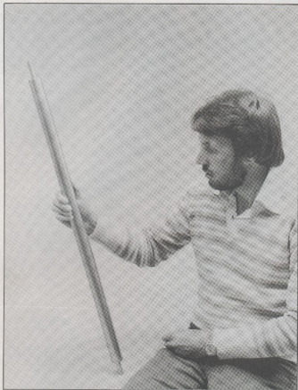
Uma pilha de sódio-enxofre; ela mede 850 x 38 mm e produz uma f.e.m. de 2,08 volts.
