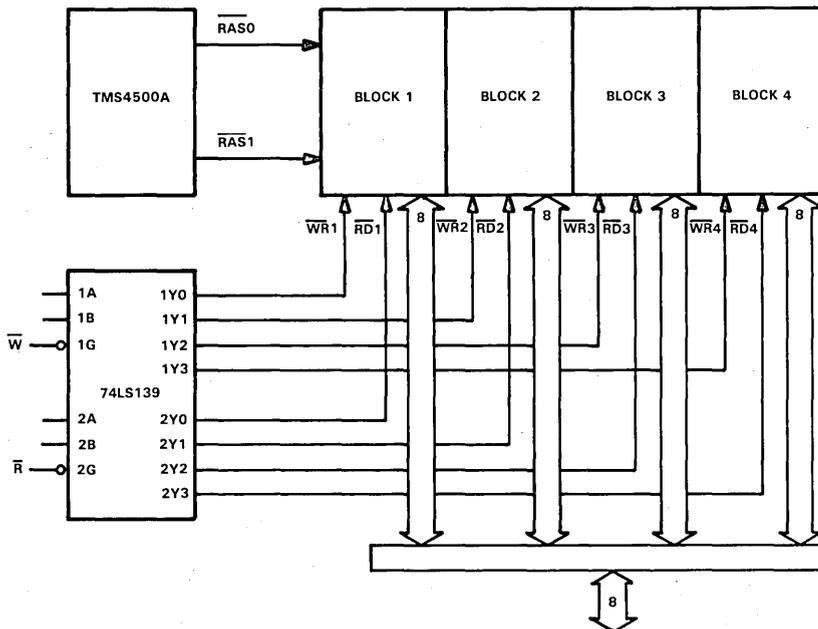
FIGURE 4 — 128K X 8 FAST ACCESS CONFIGURATION
