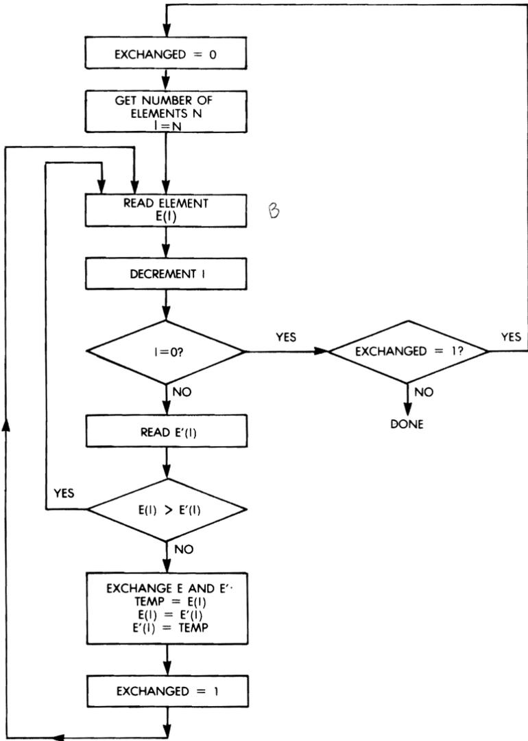
Fig. 8.7: Bubble-Sort Flowchart
