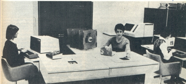
Sentry — A série Sentry de testadores automáticos, da Fairchild, inclui uma unidade de controle computadorizada (ao fundo), estações de programação (esquerda e direita) e pontas de provas múltiplas (em primeiro plano). O que aparece na foto é o mais recente da série, o Sentry VIII.
