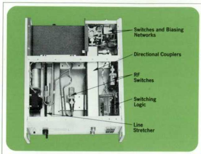
Fig. 3. Model 8745A S-Parameter Test Set.
