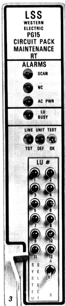
Fig. 6—LSS RT maintenance unit.
