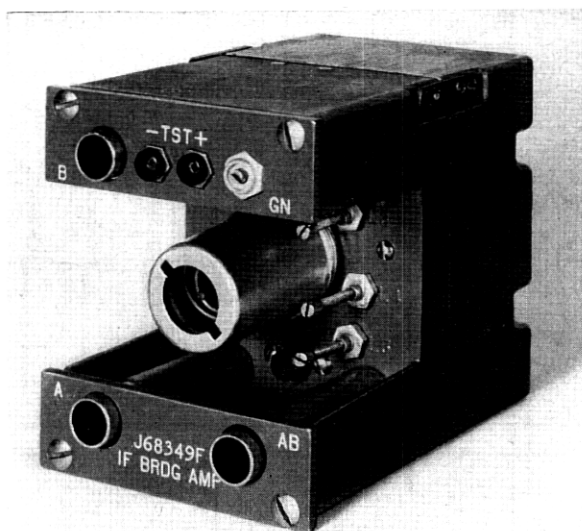
Fig. 5 — IF bridging amplifier.
