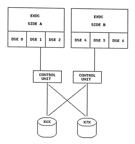
IBM 3084 PROCESSOR COMPLEX 3084 CHANNEL SUBSYSTEM MIXED MODE PHYSICAL CONFIGURATION
