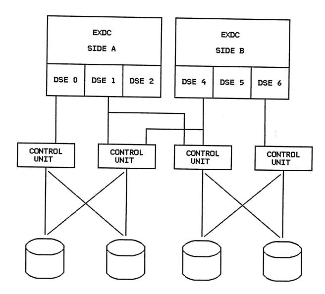
IBM 3084 PROCESSOR COMPLEX 3084 CHANNEL CONFIGURATION MIXED MODE - RUNNING SINGLE IMAGE
