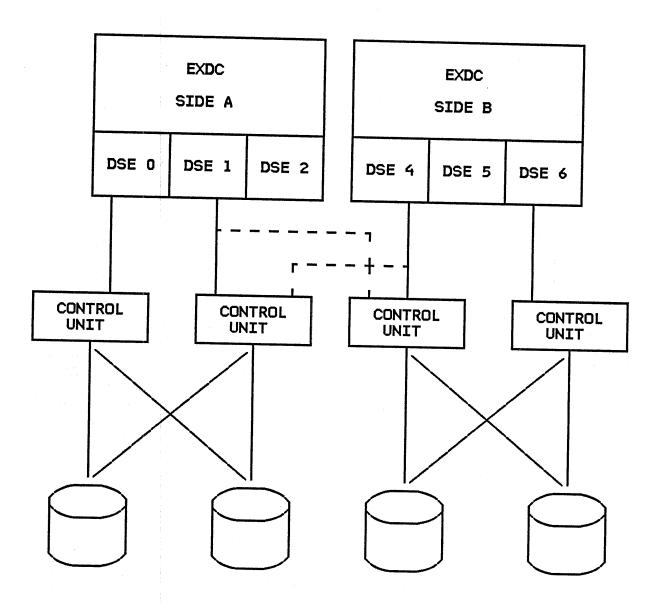
3.16 IBM WASHINGTON SYSTEMS CENTER (C) COPYRIGHT IBM CORP. 1982 IBM 3084 PROCESSOR COMPLEX 3084 CHANNEL CONFIGURATION SHARED MIXED MODE - SINGLE IMAGE
