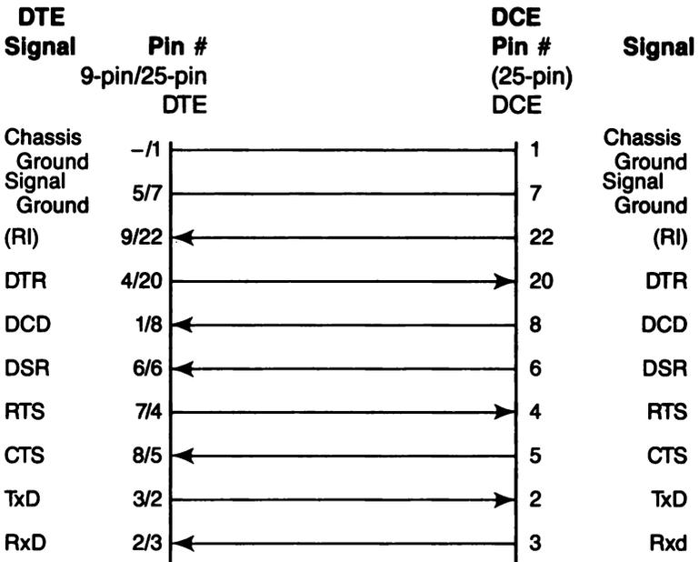
**Figure D-1. DTE-to-DCE Interface.**
